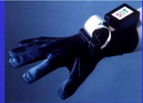
Data Glove - podatkovna rokavica - deluje kot miška
